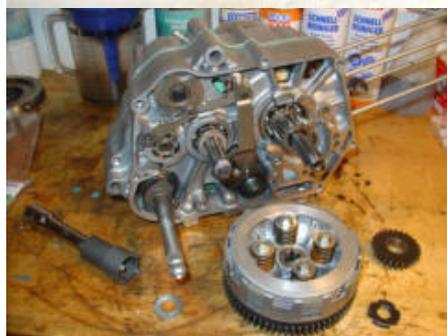
Neben dem großen Kolben und Zylinder war auch ein Takegawa Superhead mit S30-Nockenwelle im Paket. Außerdem die Teile für den Kupplungsumbau auf 5 Scheiben sowie das Dichtungsmaterial.
