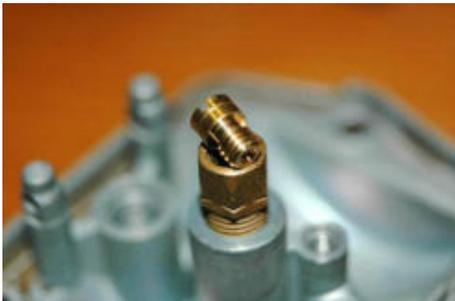
Der Düsenstock samt der Hauptdüse wird wie auf dem Bild gezeigt verbaut. Es ist völlig normal, dass ein paar Gewindegänge überstehen – also zieht nicht wie irre an, wenn's nicht mehr weiter geht, ist's gut!
