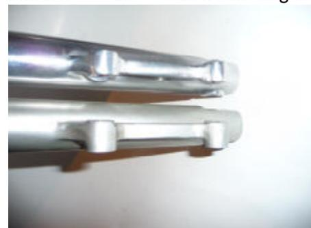
Alle Teile wurden ordentlich gereinigt, in die polierten Tauchrohre eingesetzt und alles wieder zusammengefügt.
