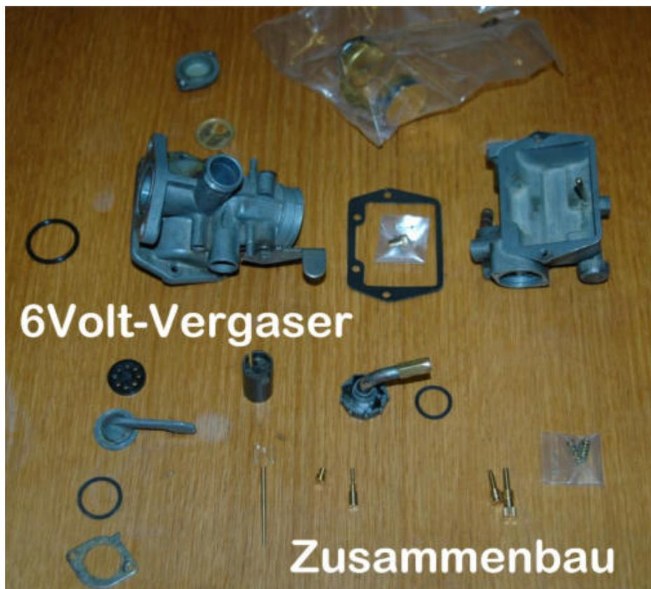
nadel, der Nadelclip (Vorsicht! Er kann weit fliegen) und der Sicherungsclip.
