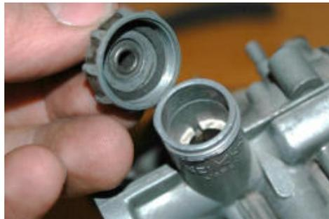
Bevor der Vergaser am Motor befestigt wird, unbedingt vorher den Gasschieber aus dem Vergaser nehmen und mit der Feder, wie auf dem Bild gezeigt, am Gasseil einhängen.
