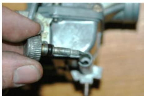
Die Ablassschraube! Sie dichtet über einen Konus am Ende den Ablauf der Schwimmerkammer ab. Ein zusätzli-
