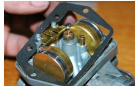
Ist das getan, geht es weiter mit der Dichtung für die Schwimmerkammer. Bei guter Erhaltung des Gummis kann diese Dichtung durchaus mehrfach verwendet werden. Ist das Gummi bereits rissig, muss Ersatz her, da sonst Kraftstoff überläuft und einem womöglich das Bike unter dem Hintern weg brennt – sofern sie überhaupt anständig läuft.
