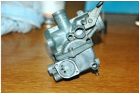
Nun die Schwimmerkammer aufsetzen und vorsichtig mit den beiden seitlichen Schrauben befestigen. Achtet darauf, dass diese Schrauben mit Gefühl angezogen werden – das Alu gibt sonst als erstes nach.
