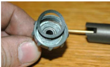
Weiter geht's mit dem Vergaserdeckel und -Schieber, welche uns nun noch zu einem fertig zusammengesetzten Vergaser fehlen. Im Deckel des Vergasers sitzt eine flache Dichtung, welche durchaus von Vorteil sein kann – etwas Falschluff hier lässt sich nur schwer finden.
