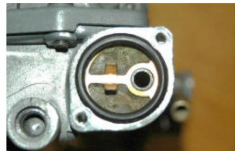
Bevor der Deckel drauf kommt, sollte überprüft werden, ob der Dicht-ring sauber sitzt und das Sieb keinerlei Beschädigungen hat und auch sonst noch „gut“ aussieht. Es ist durchaus schon vorgekommen, dass ein Sieb intakt aussah, jedoch nur noch geringe Mengen an Kraftstoff durch ließ, da es zu stark oxidiert war
