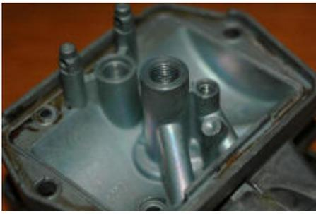
Als nächstes wird der wichtigste Teil des Vergasers zusammengesetzt: Das Oberteil, in dem alle Düsen angeordnet sind und der Choke samt dem Gasschieber verbaut werden. Wichtig ist, dass alle Kanäle frei sind! Ist hier irgendwas verstopft oder zugewachsen, muss dies unbedingt zuvor behoben werden!
