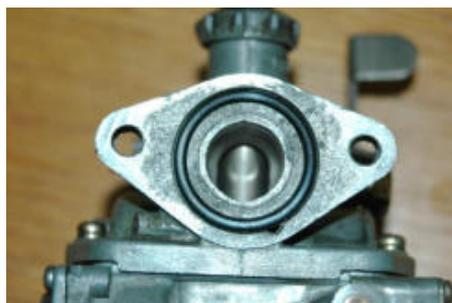
Der O-Ring am Flansch sollte auch genauer geprüft und im Ernstfall erneuert werden. Er wird nur in die Nut eingelegt und später durch den Kunststoff-Isolator gehalten. Ein defekter O-Ring macht sich hier durch Falschluff und einen fast nicht einstellbaren Vergaser bemerkbar.
