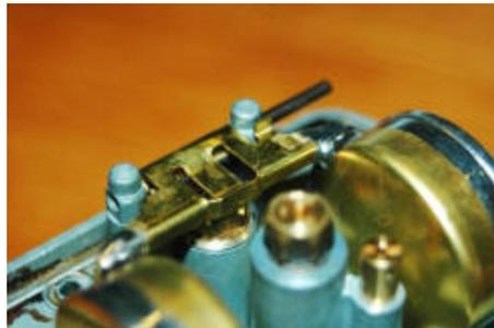
Nachdem das Nadelventil eingesetzt ist, kann nun der Schwimmer verbaut werden. Er wird lediglich durch die Achse am Vergaseroberteil gehalten und verschließt durch das Nadelventil über die kleine Lasche in der Mitte bei Erreichen des Schwimmerstandes in der Kammer den Zulauf des Kraftstoffs.
