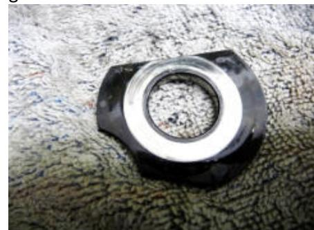
Ohne dieses Lager würde die Kupplung beim Daytonamotor auch funktionieren. Jedoch ist die Getriebewelle des 5-Gang Getriebes nicht dafür konstruiert worden. Eine deutlich verschleißfreiere Lösung bietet der Nicemotor, sowie die originalen Daytona- und Chinakupplungen. Die Axialkraft wird hier direkt über die Getriebewelle auf das innere Getriebewellenlager übertragen.
