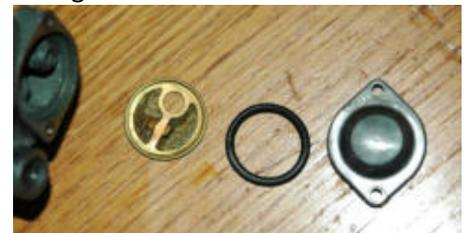
Nun geht es weiter mit dem Benzinsieb. Es besteht im Wesentlichen nur aus einem feinmaschigen Messingsieb, einem O-Ring und dem Deckel. Die Gewinde sind hier genauso empfindlich wie beim Benzinhahn, deswegen seid auch hier äußerst vorsichtig.
