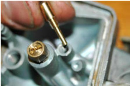
Nun geht's an das Schwimmernadelventil. Funktioniert dieses Ventil nicht mehr richtig oder ist stark verdreht, läuft ständig Kraftstoff in die Schwimmerkammer und ersäuft den Motor im Betrieb oder lässt uns gar nicht erst starten. Dieses Nadelventil ist einzeln problemlos zu bekommen.
