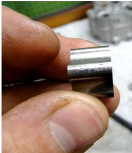
Im Rotor der Ölpumpe fanden sich einige Aluminiumspäne, die wahr- scheinlich vom Kolben stammten. Auf dem Bild sind noch die verblei- benden Krater zu sehen, welche sie hinterlassen haben, nachdem ich sie entfernt hatte. Die Ölpumpe lief zwar einwandfrei, doch aus Vorsicht habe ich sie getauscht.
