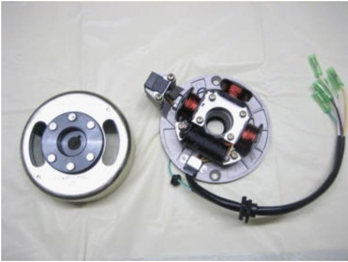
Die muss bei Verwendung der EPU potentialfrei gemacht werden, d.h. von der Masse weg. Im Falle der Jincheng Lima hat die 3 teilige Lichtspule 2 Kabel und eine Mittelanzapfung. Weiß geht an den Eingang der Spule (rote Pfeil) und gelb an der Mittelanzapfung (grüner Pfeil) Das andere Ende der Lima ist auf Masse gelegt (blauer Pfeil).
