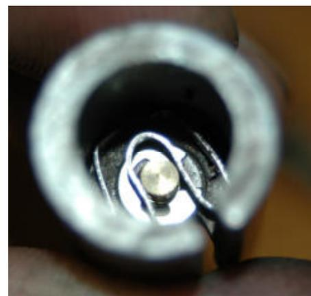
Nun wird die Düsennadel in den Schieber geführt, das allein reicht jedoch nicht, dass die Nadel an ihrer Position bleibt, und so muss der Sicherungsclip noch eingesetzt werden. Um später den Gasseilzug sauber einzuhängen, wäre die Position wie auf dem Bild gezeigt wünschenswert. Damit wäre das erste Bauteil des Vergasers schon mal betriebsbereit.
