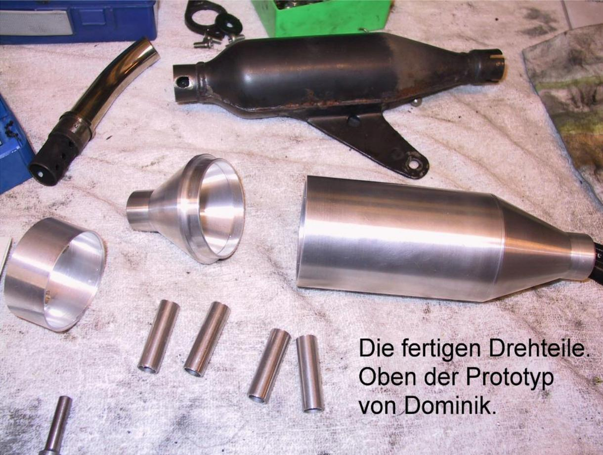
Die fertigen Drehteile. Oben der Prototyp von Dominik.
