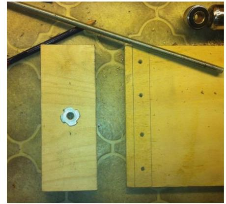
**Links:** Aus einem Stück von einem gebrochenem Spatenstiel und einem kleinen Lager aus der Dax-Grabbelkiste ist die untere Aufnahme schnell hergestellt:
