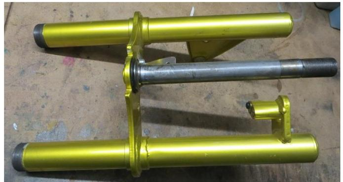
**Bild rechts:** Ich habe mir mit einem Edding markiert, wo sie abgesägt werden muss. Knapp 1cm habe ich stehen gelassen. Mit einer Drehmaschine geht es prima, mangels solch eines Werkzeugs habe ich jedoch nach der Säge gegriffen.
