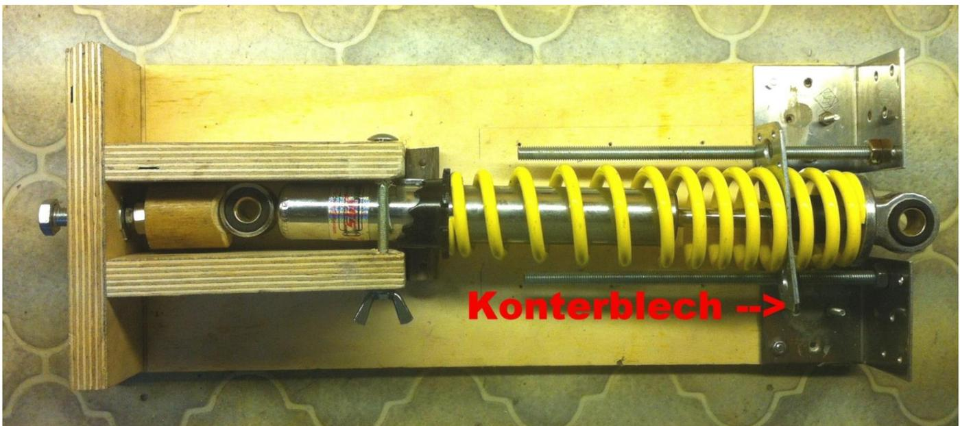
Jetzt ist die Funktionsweise schon gut zu erkennen. Der Stoßdämpfer wird eingelegt und das passende von zwei Konterblechen auf die Gewindestangen geschoben und mittels zwei 8mm Muttern fixiert. Jetzt kann die linke Schraube weiter hineingedreht werden und der untere Teil des Dämpfers wird nach rechts geschoben.
