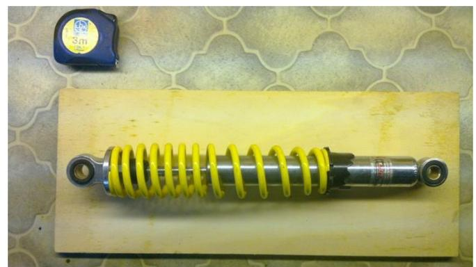
**Rechts:** Weiter ging es mit der Aufnahme für die untere (einzelne) Schraube. Das 19mm-Mehrschichtholz wurde mittig mit einem 12mm Loch und einer Einschlagmutter M10 für Holz versehen.
