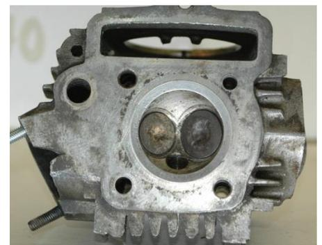
Das auffälligste an diesem Kopf ist eine deutlich breitere Fase vom Brennraum, die Ventile weisen den typischen Schlitz auf, wie wir es von
