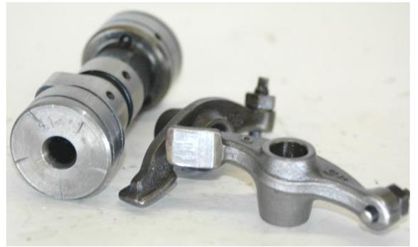
Nockenwelle und Kipphebel ST50 6V
