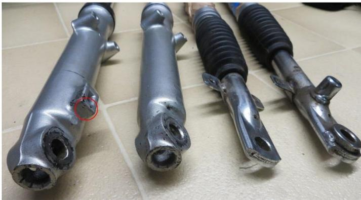
Ich habe mich dafür entschieden, die Bremsplatte und das Ausgleichsrohr an der Nabe zu bearbeiten. An beiden Seiten muss etwas Material abgetragen werden, damit das Vorderrad wieder mittig zwischen den breiteren Tauchrohren sitzt und die Standrohre nicht verzogen werden. Auch muss an dem linken Tauchrohr, im Bereich des roten Kreises, etwas Material entfernt werden damit es satt an der Bremsplatte liegt. An der linken Seite wird von der Bremsplatte 3mm entfernt (mit der Feile)
