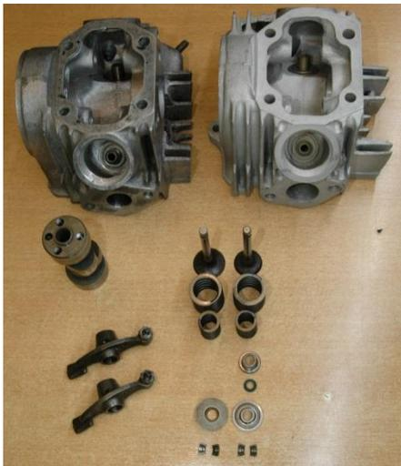
Der klassische 6V Kopf. Nockenwellenlagerung wie von den ST70 bekannt. Ventile wie ST70 GB1. Optisch unauffällig. Daten:
